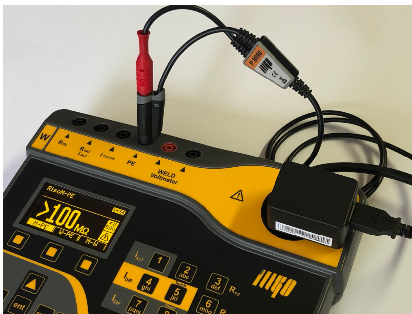
Obrázek 4: Měření izolačního odporu dobíjecího zdroje s USB konektorem pomocí P 8090 přístrojem REVEXmax
