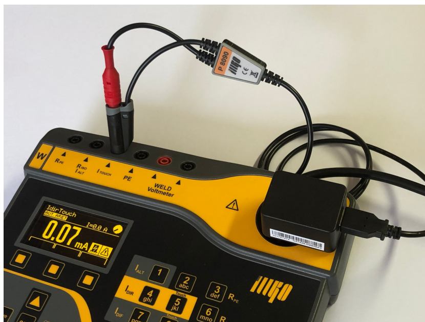
Obrázek 3: Měření dotykového proudu dobíjecího zdroje s USB konektorem pomocí P 8090 přístrojem REVEXmax
