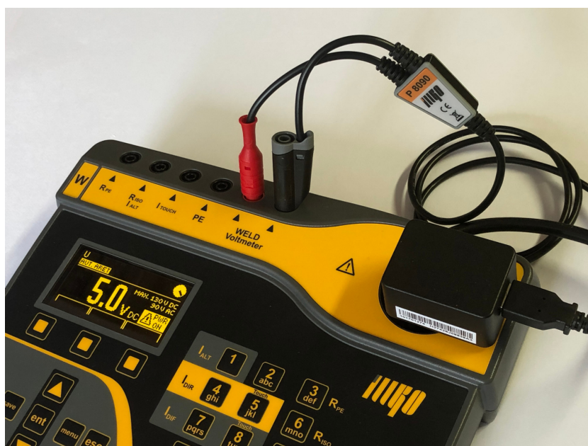
Obrázek 1: Měření výstupního napětí dobíjecího zdroje s USB konektorem pomocí P 8090 přístrojem REVEXmax
