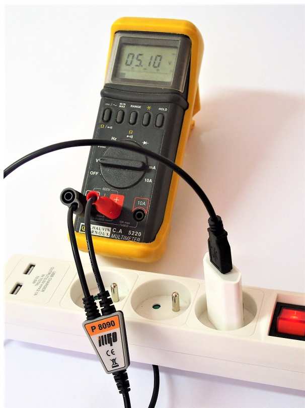
Obrázek 2: Měření výstupního napětí dobíjecího zdroje s USB konektorem pomocí P 8090 stolním multimetrem
