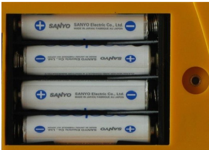
Obr. 4.1 Správná polarita napájecích článků
