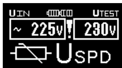
Obr. 3.4b Příklad výsledku měření (zvoleno měření přepětových ochran)
