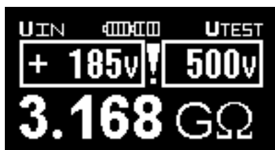
Obr. 3.7a Příklad výsledku měření (probíhá vybíjení náboje)
