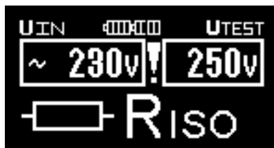
Obr. 3.1 Příklad zobrazení při měření napětí
