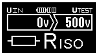
Obr. 3.5 Příklad nastavení pro měření izolačních odporů
