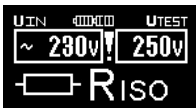
Obr. 3.4a Příklad výsledku měření (zvoleno měření izolačního odporu)
