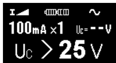
Obr. 3.4b Dotykové napětí > 25 V
