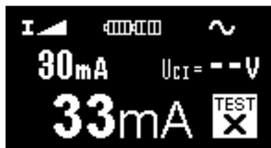
Obr. 3.15b Příklad výsledku měření, pokud proudový chránič nevybavil
