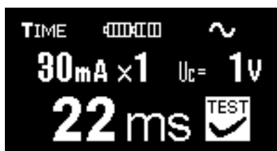
Obr. 3.12a Příklad výsledku měření vypínacího času
