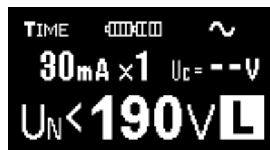
Obr. 3.16b Příklad indikace přítomnosti fázového napětí
