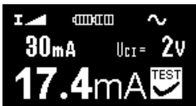
Obr. 3.15a Příklad výsledku měření vybavovacího proudu
