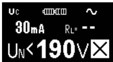
Obr. 3.8 Příklad nastavení pro měření dotykového napětí
