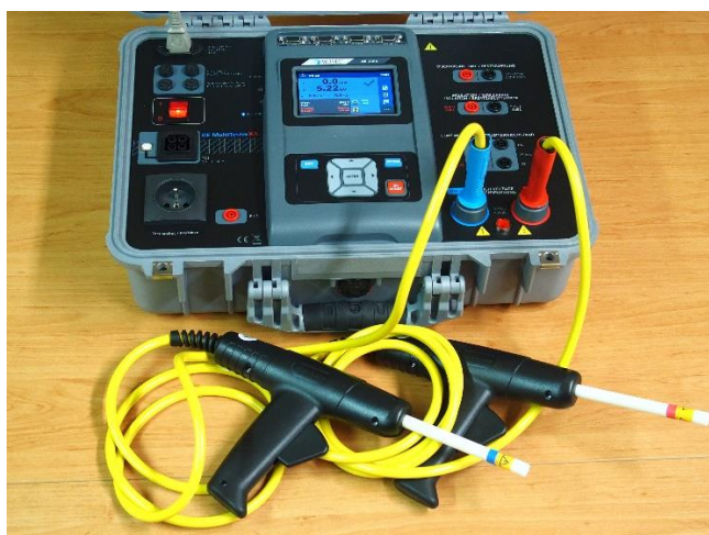
Obr. 8 – Sestava přístroje MI 3394 s VN měřicími hroty
