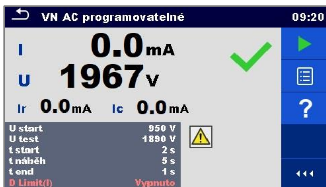
Obr. 7 – Měření impulzního výdržného napětí
