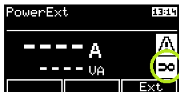
Abbildung 47: Aktivierung des Eingangs für externes Messgerät
