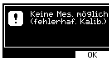
Abbildung 28: Warnmeldung: Keine Messung möglich (fehlerhafte Kalibrierung)
