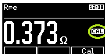
Abbildung 46: Fehler Widerstandsausgleich Messkabel
