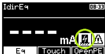
Abbildung 36: Hinweis auf den erforderlichen isolierten Masseschluss des Geräts
