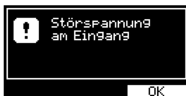
Abbildung 25: Warnmeldung: Störspannung am Eingang
