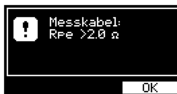
Abbildung 34: Warnmeldung: Messkabel: Rpe >2.0 Ω
